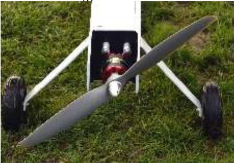
Der Motor mußte erst umgebaut werden um den Propellermitnehmer an der Glocke befestigen zu können, die beiliegende Distanzhülsen vereinfachen die Motor-montage mit dem Motorträger aus Alu. Nun stellte sich die Frage wie der Regler am besten unter zu bringen ist um wenigstens ein Mindestmaß an Kühlung zu gewährleisten.
