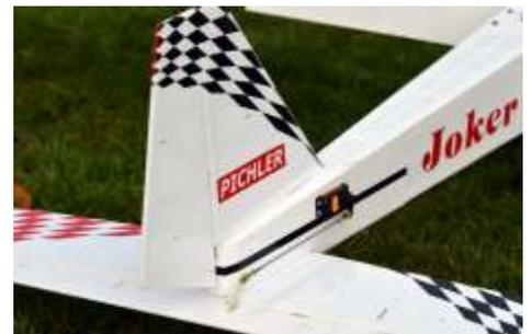
Abweichend zum eigentlichen Plan haben wir das HLW mit zwei M3 Schrauben abnehmbar gestaltet, was den Transport sehr erleichtert.
