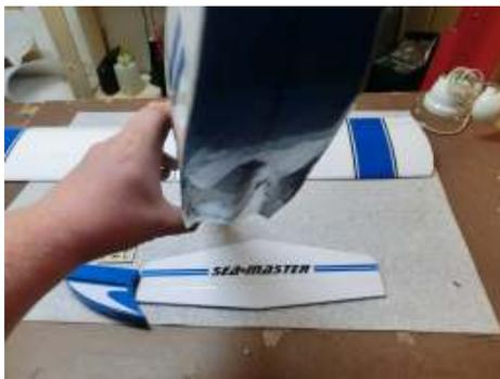
Hier mal der Unterboden. Dabei wurde kein Kunststoffteil verwendet, lediglich Depron mit selbstklebender Folie überzogen. Die Abrisskante ist messerscharf. Beide seitlichen Kanten sind mit einem Streifen ABS verstärkt, damit sie nicht so leicht eingedrückt werden.
