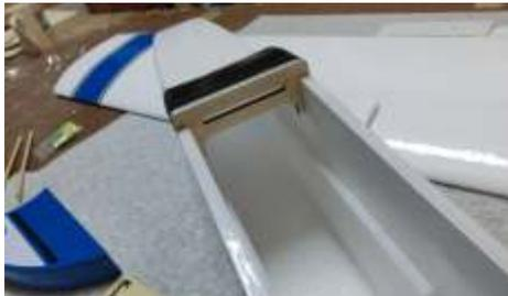
Innen ist alles Wasserdicht mit Silikon abgedichtet.
