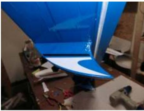
Die seitlichen Stützwimmer werden mir Uhu Por an die Tragfläche geklebt.
