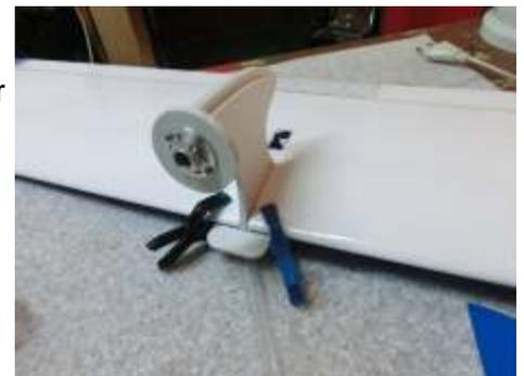
Der Motorpylon mit bereits fertig montiertem Motorhalter. Sturz und Zug sind damit schon vorgegeben und passen somit selbst im Rückenflug Perfekt.
