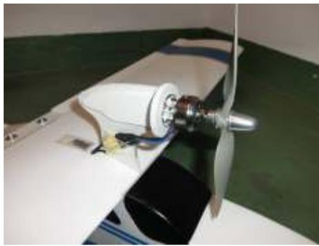
Die Motorkabel verlaufen hinter dem Motorpylon in den Rumpf. Die Durchführung ist mit Uhu Por abgedichtet. Dahinter sieht man das Querruderservo. Leider habe im Moment kein weißes Klebeband, daher noch der Schwarze Fleck
