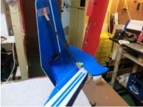
Die Höhenruder Abstützung habe ich aus CFK-flachprofil gefertigt, sie sind nur an einer Seite verklebt und die andere ist lediglich mit Tape fixiert. Dadurch kann ich jederzeit das Höhenruder dem Tragflächen Winkel anpassen. Die Befestigungshülsen sind platt gedrücktes dünnwandiges Aluminium. Mit Uhu Por an die Rumpfseite geklebt und mit Tape gesichert.
